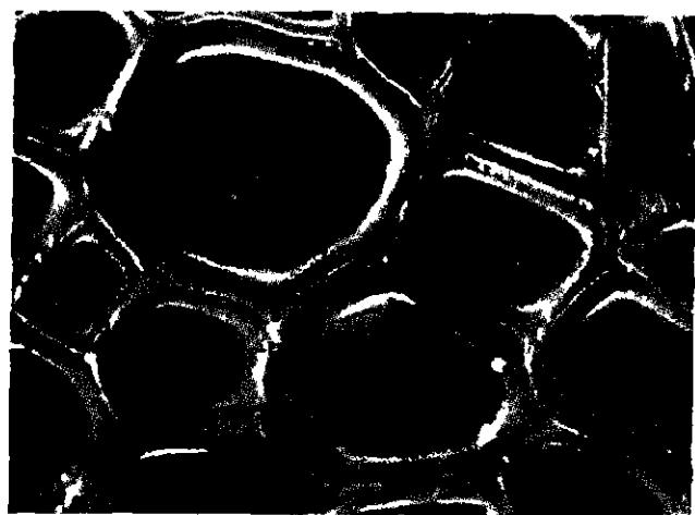
Поперечный разрез волокна древесины осины (увеличено в 1760 раз). Такая структура с тонкими целлюлозными стенками и большими пустотами типична для волокон молодых деревьев. Пространство между отдельными волокнами заполнено лигнином, играющим роль связующего вещества.
